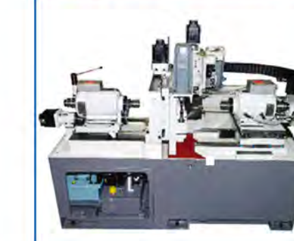
Das Guß-Maschinenbett reduziert Schwingungen der Maschine auf ein Minimum. Mit dem integrierten Kühlmittelank wird der Wärmegang der Maschinen minimiert, da sich die Maschinentemperatur kontinuierlich der Kühlmittel-Temperatur anpasst.
