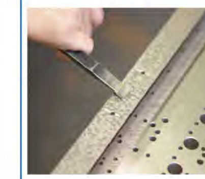
Die handgeschabten Führungen gewährleisten eine maximale Dämpfung und höchste Präzision am Werkstück.
